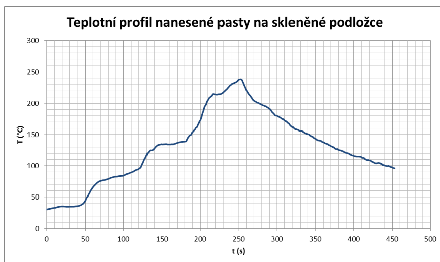
Obrázek 23: Graf naměřeného teplotního profilu v průběžné pájecí peci Mistral
